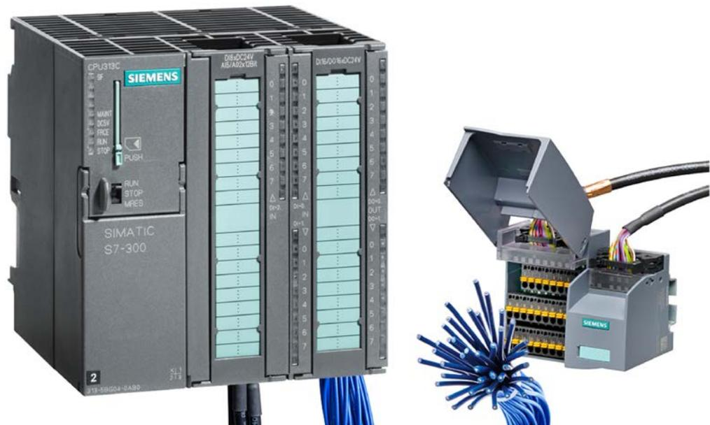
Bild 3-1 SIMATIC TOP connect mit einer S7-300
