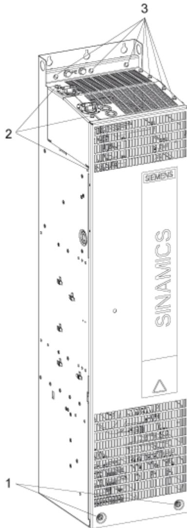
Bild 3-4 Montage des Braking Module in ein Power Module Baugröße FX – Schritt 1 - 3
