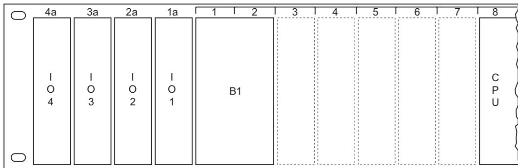
IO1, IO2, IO3, IO4      I/O modules
