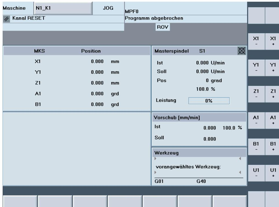
Bild 2-2: Beispiel mit eingblendeter Beschriftung der Verfahrachsen
