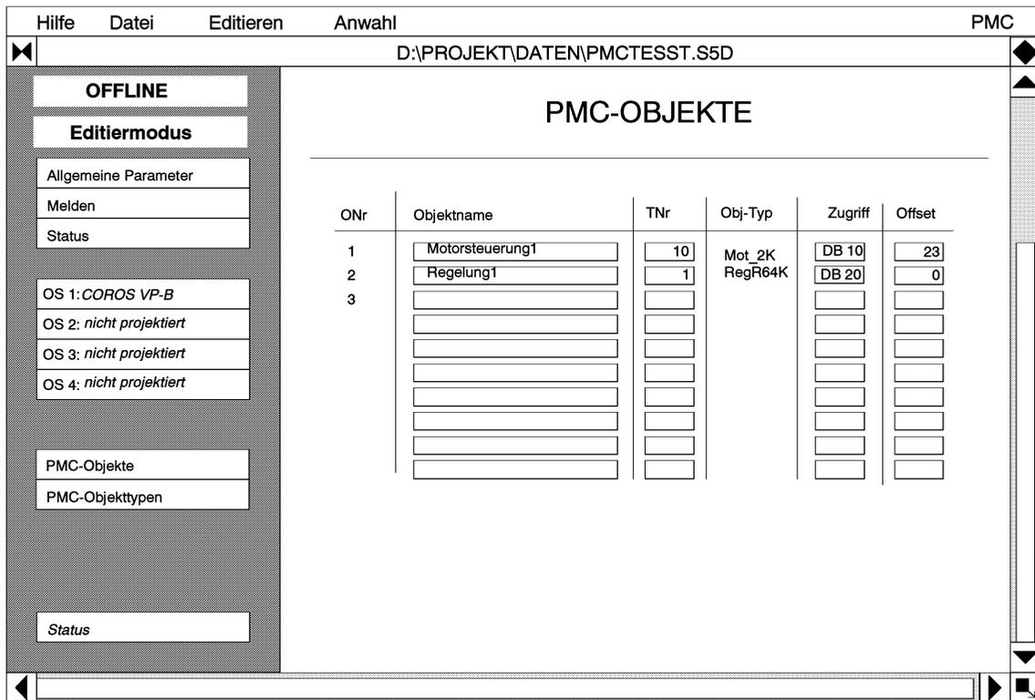
Hier können Sie die PMC-Objekte für die Statusüberwachung angeben. Eigene Objekte können in der Maske PMC-Objekttypen definiert werden.
