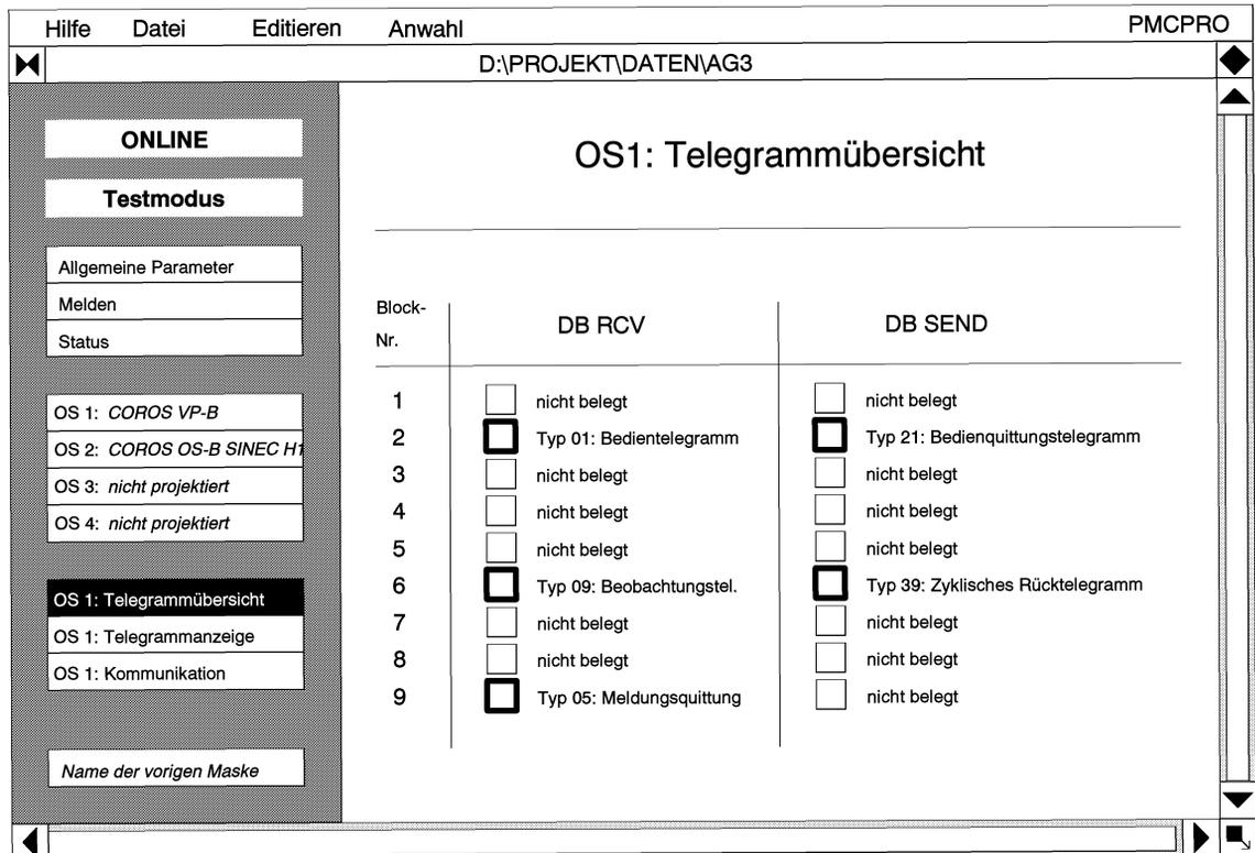
Mit einem Einfachklick auf die quadratischen Schaltflächen vor den Texten in der Tabelle DB RCV und DB SEND ist ein Wechsel in die Maske "Telegrammanzeige" unter folgenden Bedingungen möglich:
