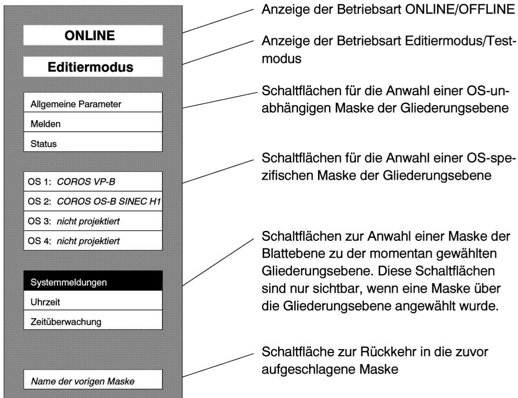
Die Palette wird in allen Masken angezeigt. Die Schaltfläche für die aktuelle Maske wird invers dargestellt.
