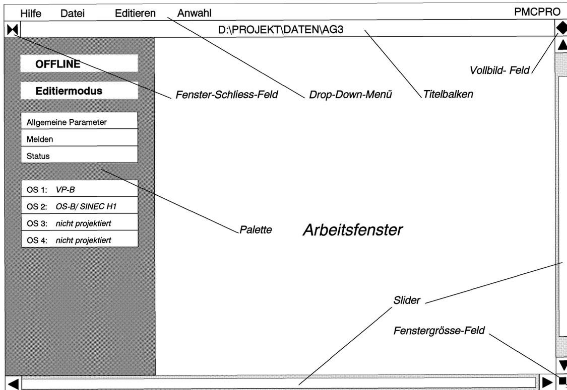
**Arbeitsfenster** Auf der Fläche des Arbeitsfensters werden die verschiedenen Formulare eingblendet, über welche die Projektierung erfolgt.
