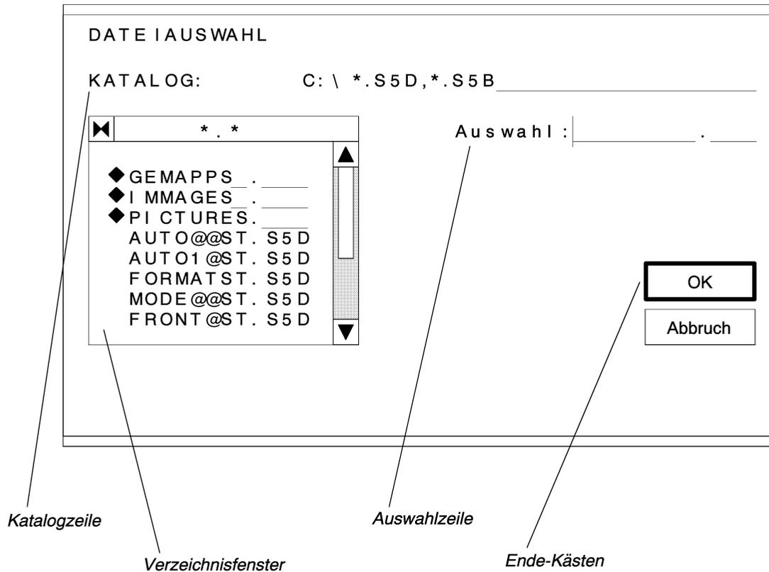
Um eine Datei anzulegen, wird der gewünschte Dateiname in die Auswahlzeile eingetragen. Es genügt, den Namen der Datei einzugeben. Die Endung ST.S5D wird durch das System selbständig angefügt.
