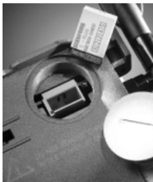
Bild 3-28 Entnehmen des C-PLUG aus dem Schacht
