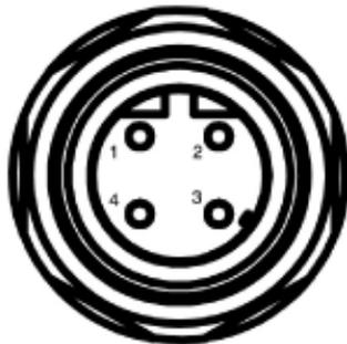
Bild 3-10 SCALANCE 208PRO Ethernetbuchse M12
