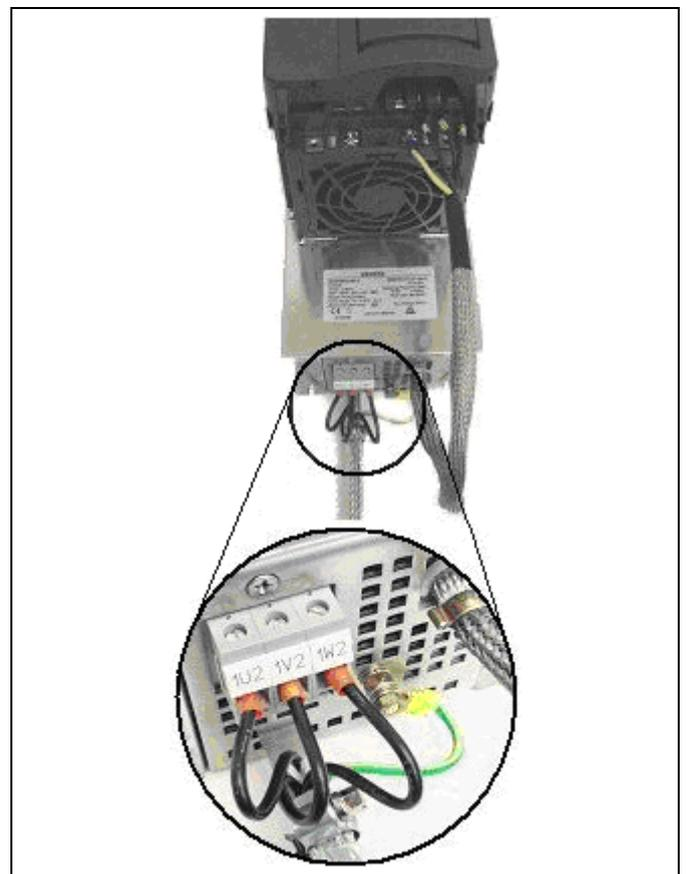
Bild 6 Schirmung, LC-Filter Bauform A
