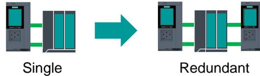
Single-Mode für R-CPU's für einfaches Upgrade von einem Single- auf ein redundantes System
