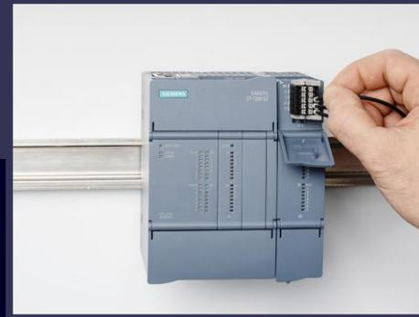
Abnehmbare Klemmenblöcke mit hoher Dichte und Push-in-Verdrahtung für einfache Bedienung → und berührungslos Vorverdrahtungsposition.
