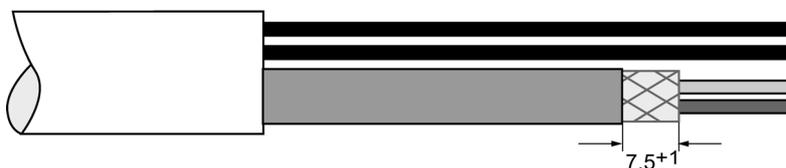
Bild 4-9 PROFIBUS Hybrid Leitung mit Schrumpfschlauch
