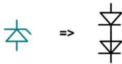
2 x ZPD1 Dioden in Serie für 0..+20/24 mA Eingänge
