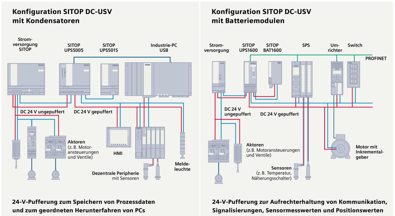
**24-V-Pufferung zum Speichern von Prozessdaten und zum geordneten Herunterfahren von PCs**
