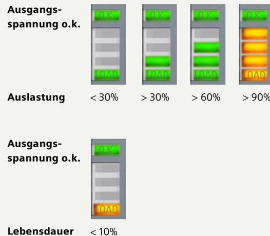
Die Diagnoseschnittstelle gibt einen seriellen Code an einen Digitaleingang einer SPS, der von einem Funktionsbaustein ausgewertet wird. Die einfache Visualisierung ermöglicht ein WinCC-Faceplate:
