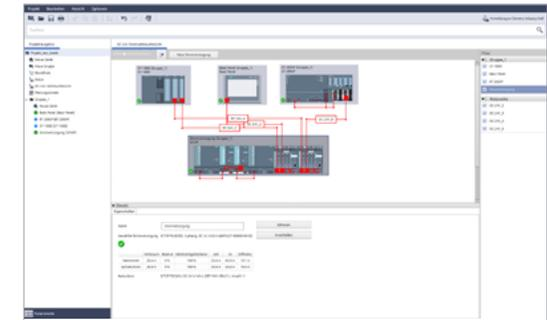
TIA Selection Tool: In der 24-V-Verbrauchersicht kann die erforderliche SITOP Stromversorgung für ausgewählte Automatisierungsprodukte einfach selektiert werden.
