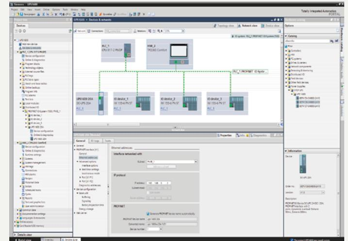
Über das TIA Portal ist die Einbindung der DC-USV SITOP UPS1600 in PROFINET einfach und fehlersicher.
