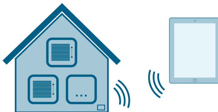
Abbildung 1-1: Zentralsteuerung mit dem LOGO! TDE in der Gebäudeautomation
