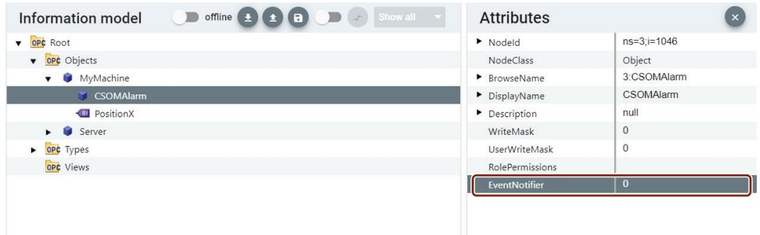
Bild 4-30 Unter einer Variable für Alarm hinzugefügte neue Instanz
