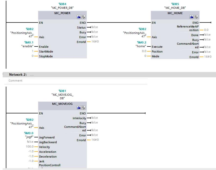
图 2-17 在 S7-1511T 中编写从轴使能、回零、故障复位程序
