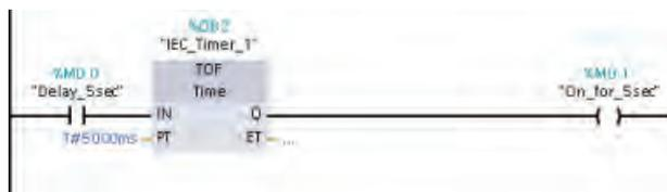
Lorsque la temporisation TON active "Delay\_5sec", la temporisation TOF met le bit "On\_for\_5sec" à 1 pendant 5 secondes.
