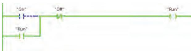
Désactivez maintenant le commutateur pour I0.1 pour supprimer le flux de courant de la bobine "Run" (Q0.0).
