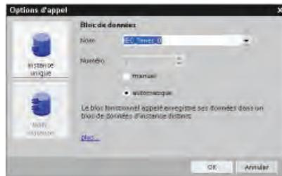
Le placement de l'instruction TON dans le réseau crée automatiquement un bloc de données mono-instance (DB) pour le stockage des données de la temporisation.
