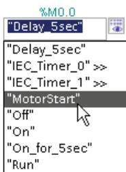
La sortie "Delay\_5sec" (un bit en mémoire M) n'est désormais plus nécessaire pour démarrer la temporisation TOF. N'effacez pas la sortie "Delay\_5sec" mais renommez-la simplement.
