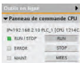
Servez-vous des boutons sur le panneau de commande pour changer l'état de fonctionnement (ARRET ou MARCHE). Le panneau de commande dispose également d'un bouton MRES pour réinitialiser la mémoire.
