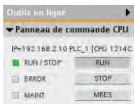
Servez-vous du panneau de commande de la CPU pour changer l'état de fonctionnement. Cliquez sur les boutons "MARCHE" ou "ARRET" pour changer l'état de fonctionnement de la CPU.
