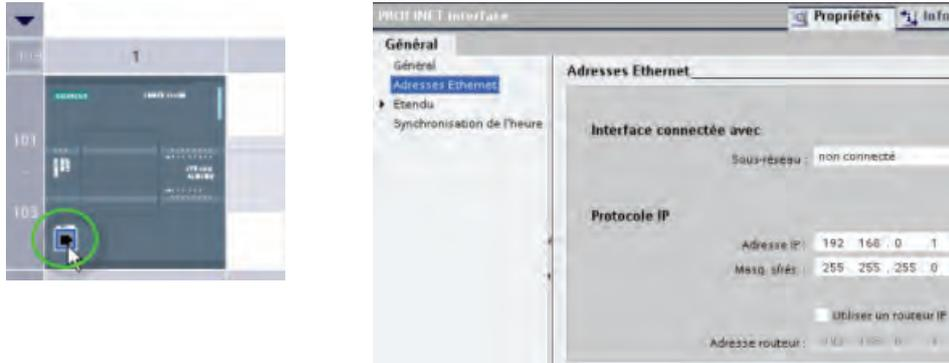
1. Sélectionnez le port PROFINET sur la CPU afin d'afficher uniquement les propriétés de l'interface PROFINET. Vous pouvez également sélectionner "Interface PROFINET" dans les propriétés "Général" de la CPU.
