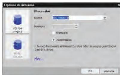
Quando si trascina l'istruzione TON sul segmento viene creato automaticamente un blocco dati (DB) di istanza singola per la memorizzazione dei dati di temporizzazione.
