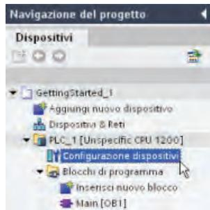
Per caricare la configurazione hardware della CPU si può utilizzare la funzione di rilevamento CPU di Configurazione dispositivi.
