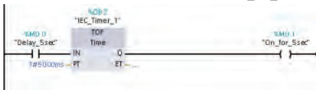
Quando il temporizzatore TON attiva "Delay\_5sec" il temporizzatore TOF attiva il bit "On\_for\_5sec" per 5 secondi.
