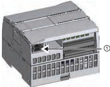
① Inserire un'estremità del cavo PROFINET nella CPU.
