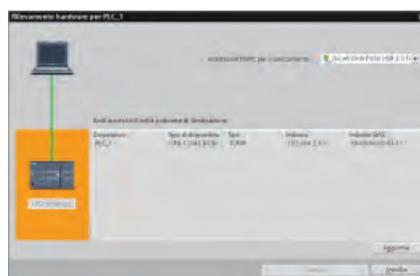
STEP 7 Basic "rileva" qualsiasi CPU collegata al computer. Selezionare la CPU e fare clic sul pulsante "Carica" per caricare nel progetto la configurazione della CPU.
