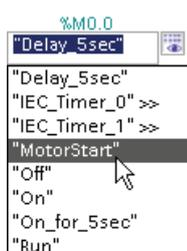
L'uscita "Delay\_5sec" (un bit della M) per l'avvio del temporizzatore TOF non è più necessaria. Invece di cancellare l'uscita "Delay\_5sec" la si può rinominare.
