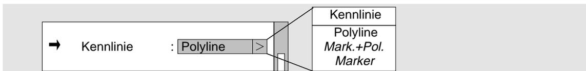
Bei der Darstellung des Kurvenverlaufs können Sie bei GRACIS OLB zwischen *Polyline*, *Marker* und *Marker+Polyline* wählen. Bei GRACIS ULB wird der Kurvenverlauf immer als Polyline dargestellt.
