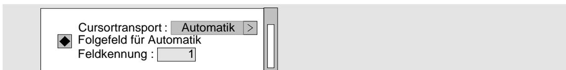
Bei Cursortransport durch Automatik können Sie ein Folgefeld definieren, in das der Cursor springt, nachdem eine Eingabe übernommen wurde. Parametrieren Sie kein Folgefeld, springt der Cursor, wie beim Betätigen der Elementcursortaste `Ab' ohne parametriertes Folgefeld.
