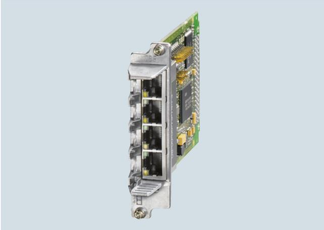
Mit dem Communication Board CBE30-2 kann SIMOTION D4x5-2 DP/PN mit einer zweiten PROFINET-Schnittstelle ausgerüstet werden.
