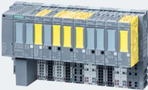
Das skalierbare Peripheriesystem SIMATIC ET 200SP ist ein hochflexibles modulares Peripheriesystem in Schutzart IP20. Über Interfacemodule mit PROFINET- oder PROFIBUS-Schnittstelle kann es mit einer überlagerten Steuerung I/O-Daten der angeschlossenen Peripheriemodule austauschen. Für außergewöhnliche Anforderungen und hohe Robustheit stehen ET 200SP-Komponenten als SIPLUS Variante zur Verfügung.
