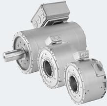
Die Komplett-Torquemotoren SIMOTICS T-1FW3 sind wassergekühlte, hochpolige, permanentmagneterregte Synchronmotoren. Das Motorenspektrum 1FW3 umfasst 3 Außendurchmesser in verschiedenen Achslängen sowie 3 unterschiedliche Wellenausführungen (Hohlwelle, Aufsteckwelle und Vollwelle).
