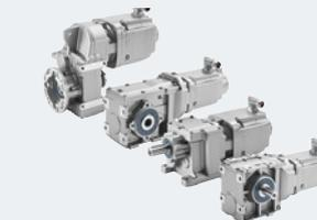
SIMOTICS S-1FG1 sind kompakte Servogetriebemotoren, die als komplette Einheit fertig montiert und mit ölbefülltem Getriebe geliefert werden. Das Typspektrum umfasst Stirnrad-, Flach-, Kegelrad- und Stirnradschnecken-Getriebemotoren, die je nach Getriebeart und Baugröße in bis zu 25 Übersetzungen verfügbar sind.
