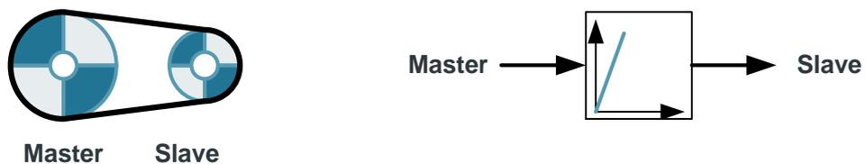
**Hinweis** Getriebegleichlauf ist in der SIMATIC S7-1500 nur ohne Synchronposition möglich. Für einen Getriebegleichlauf mit Synchronposition ist eine SIMATIC S7-1500T notwendig (siehe Gegenüberstellung in Kapitel [1.2](#)).
