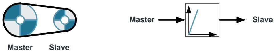
Beim Geschwindigkeitsgleichlauf wird die Folgeachse mit den vorgegebenen Dynamikwerten auf die Geschwindigkeit der Leitachse aufsynchronisiert. Sobald sich die Folgeachse synchron zur Geschwindigkeit der Leitachse befindet, ändert sich deren Geschwindigkeitsbeziehung nicht mehr.
