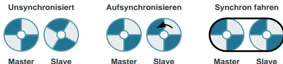
**Hinweis** Beachten Sie für die Ausgleichsbewegung der Folgeachse die zulässigen dynamischen Beschränkungen und die zulässige Bewegungsrichtung der Achse (Reversieren der Folgeachse abhängig von der Aufsynchronisierungsbedingung).
