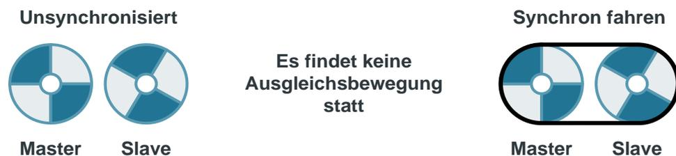
**Hinweis** Wird die Kopplung im Stillstand mit den in den gewünschten Positionen zueinander stehenden Achsen durchgeführt, ändert sich im Anschluss bei der Bewegung der Achsen die Lagebeziehung zueinander nicht mehr. Mit dieser Einschränkung kann auch ein Gleichlauf mit Synchronposition erzielt werden.
