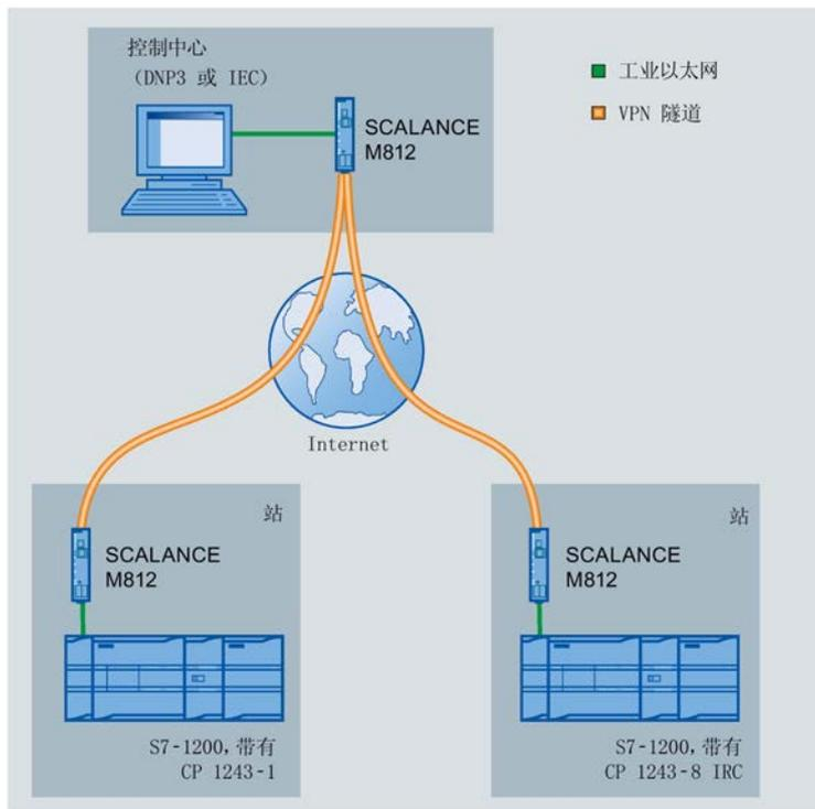
图 1-5 通过 Internet 进行连接的组态示例
