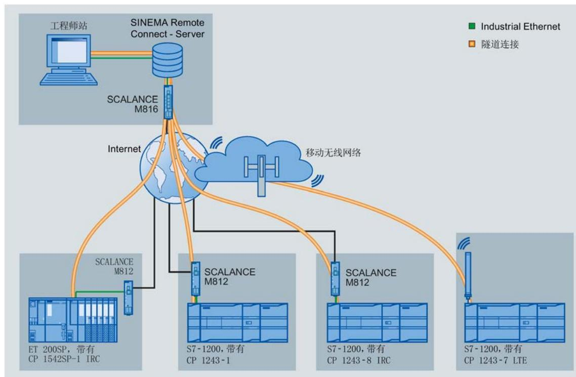
图 1-7 各工作站通过 SINEMA RC 与工程师站的连接
