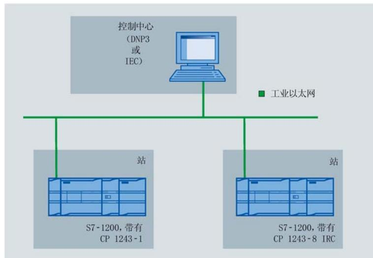
图 1-4 采用非冗余控制中心并且从站处于同一 IP 子网中的组态示例
