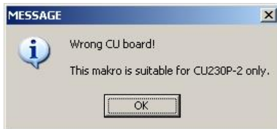
Fig. 4-5: Message, incorrect CU module
