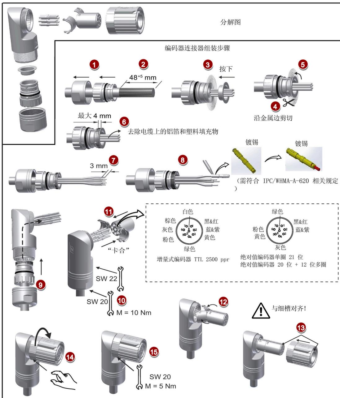
用于带直角连接器电机的编码器电缆（SH50 低惯量电机以及高惯量电机）
