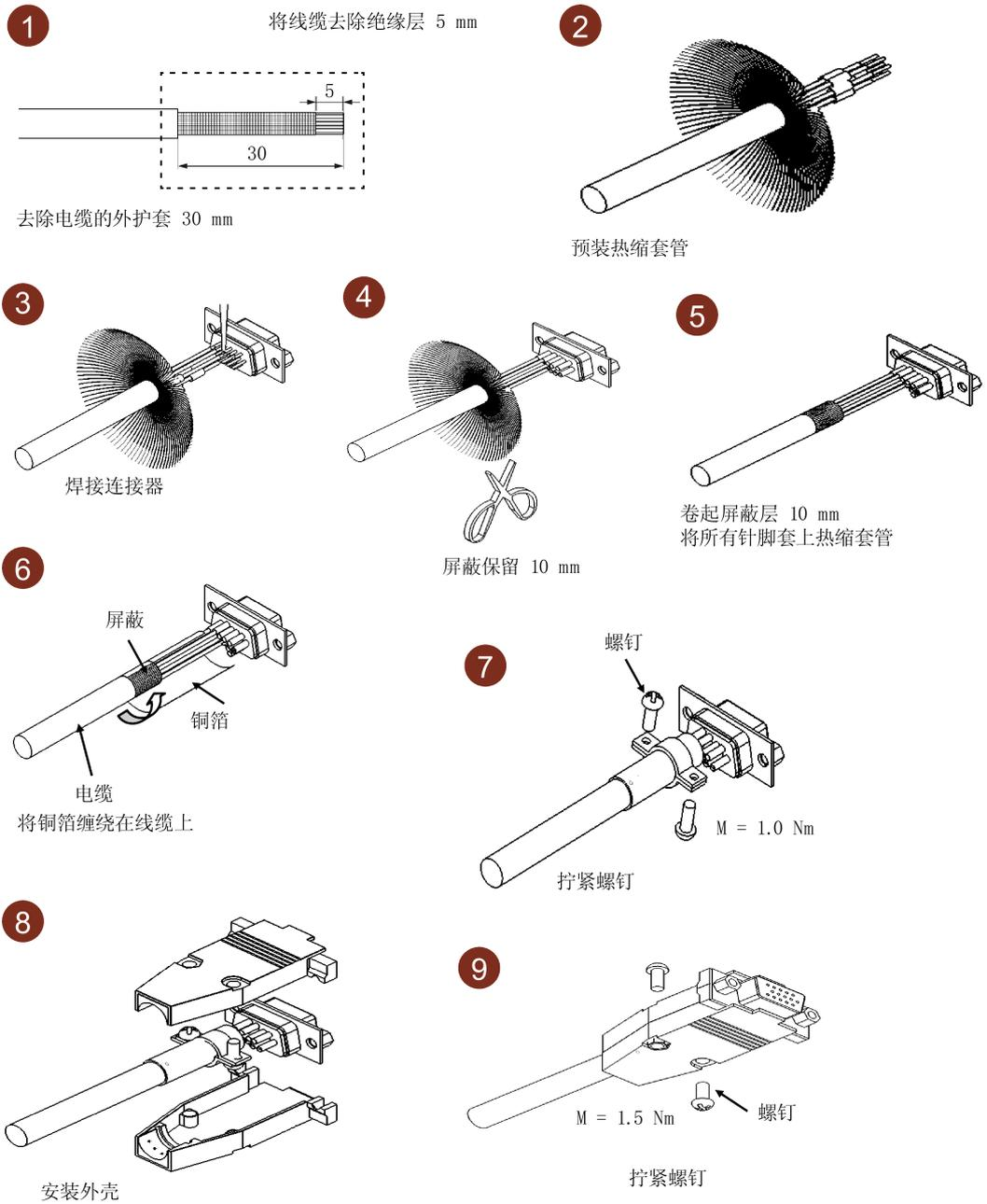
用于带直型连接器电机的编码器电缆（高惯量电机）
