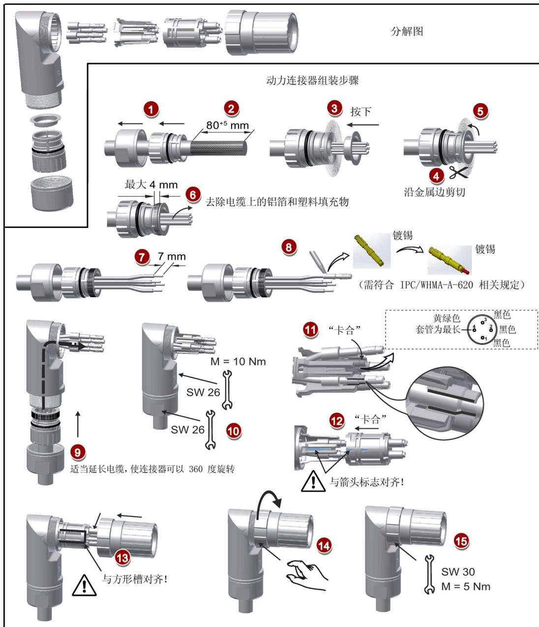
用于带直角连接器电机的电机动力电缆（SH50 低惯量电机以及高惯量电机）
