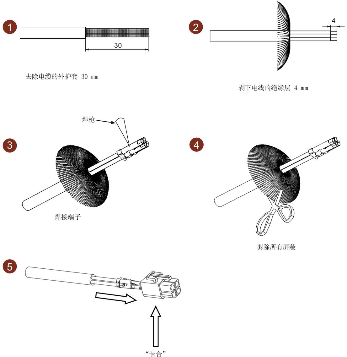
用于带直型连接器电机的电机动力电缆（高惯量电机）
