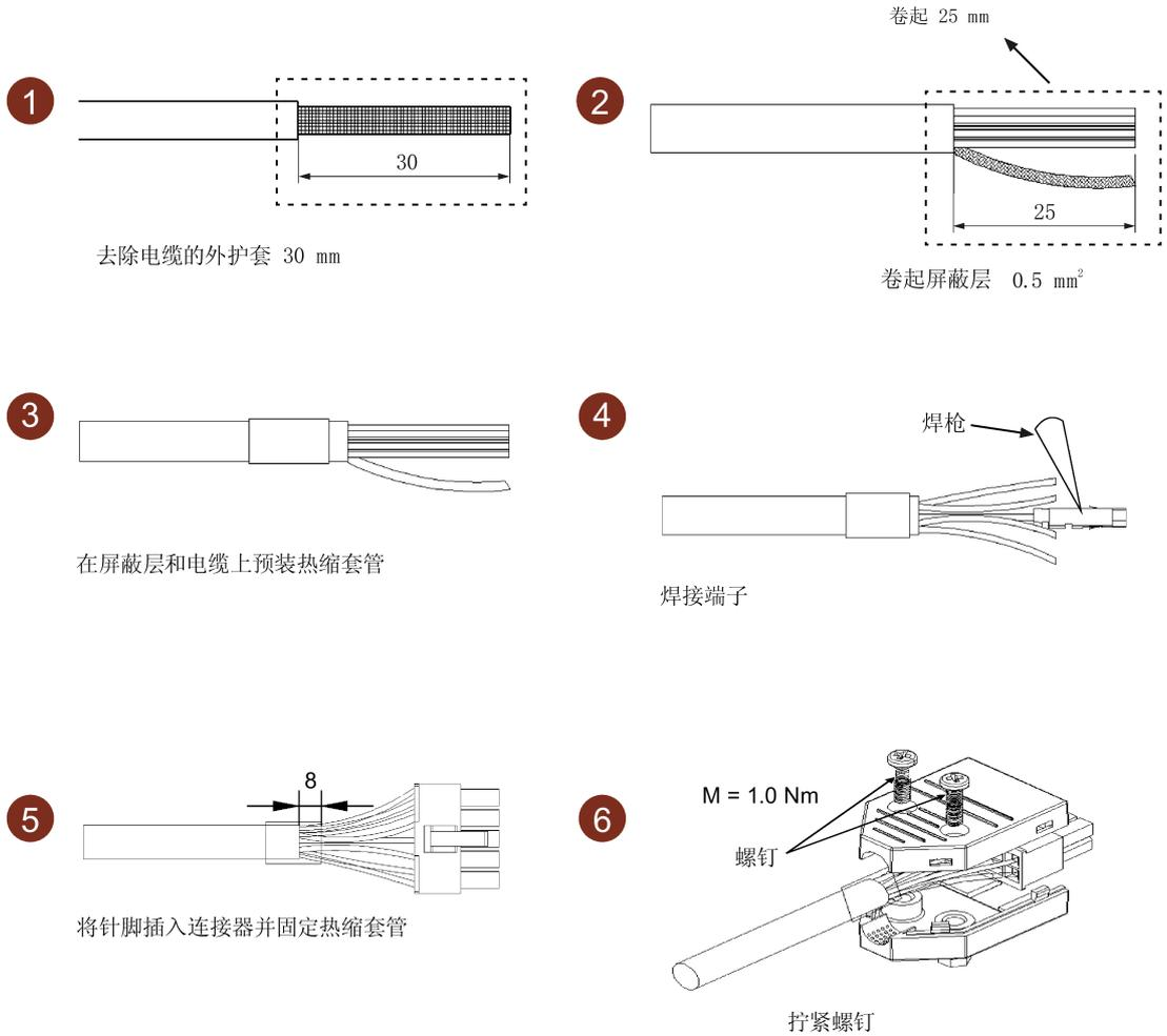
用于低惯量电机的绝对值编码器电缆 (SH20、SH30、SH40)
