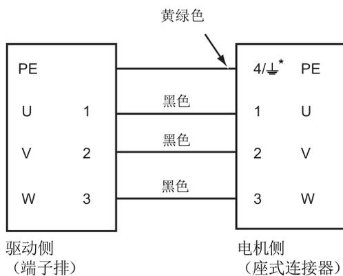
\* 4 : 带直型连接器的高惯量电机及低惯量电机 SH20、SH30 和 SH40
