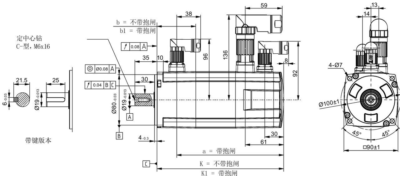
轴高 45 mm, 带增量式编码器和直角连接器
