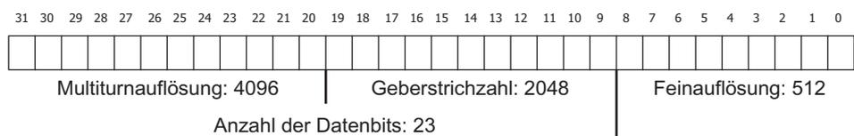
Bild 8-3 Beispiel Zusammensetzung der 32 Bit-Geberdaten des Absoluten Istwertes Gn\_XIST2
