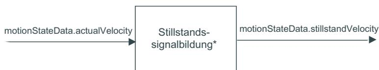
\* Das Stillstandssignal wird gebildet, wenn die Istgeschwindigkeit kleiner ist als die bei der Konfiguration eingestellte Geschwindigkeit für das Stillstandssignal.
