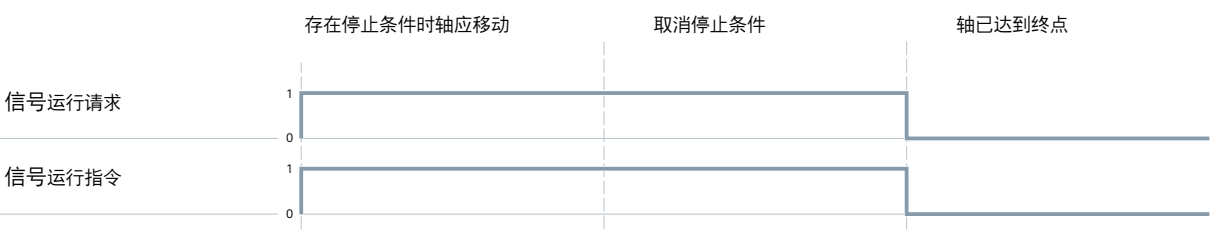
图 16-1 “信号—时间”图：设定行程的通过手轮进行的手动运行，停止条件不是终止标准 MD17900 $MN_VDI_FUNCTION_MASK 位 0 = 0
