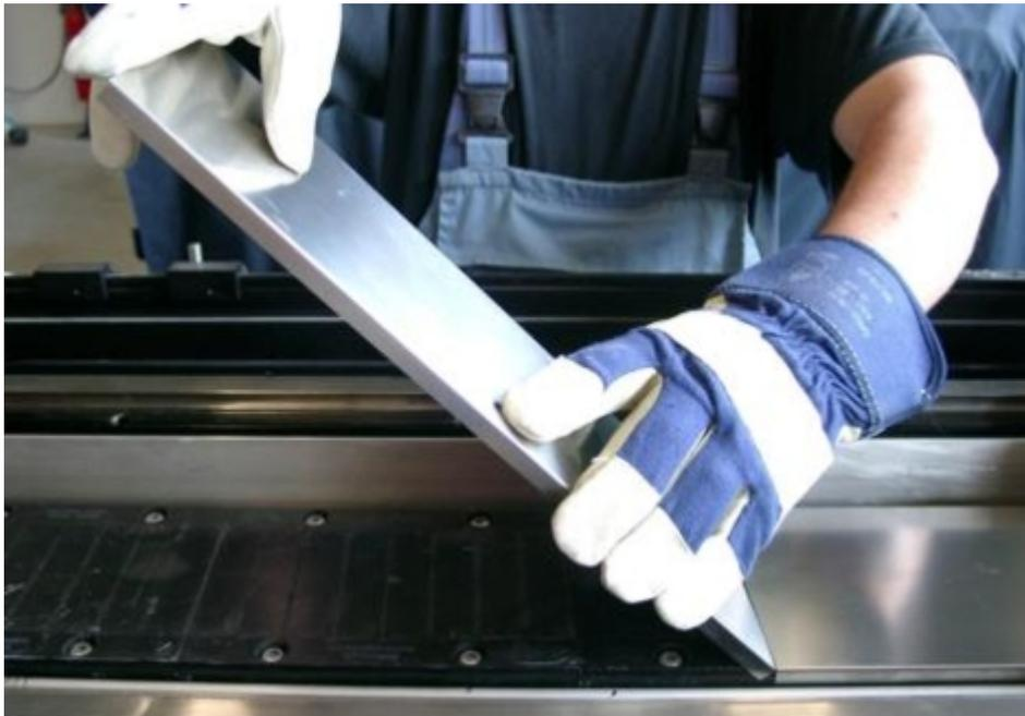
图 4-9 分段式盖板上下一段盖板的安装
