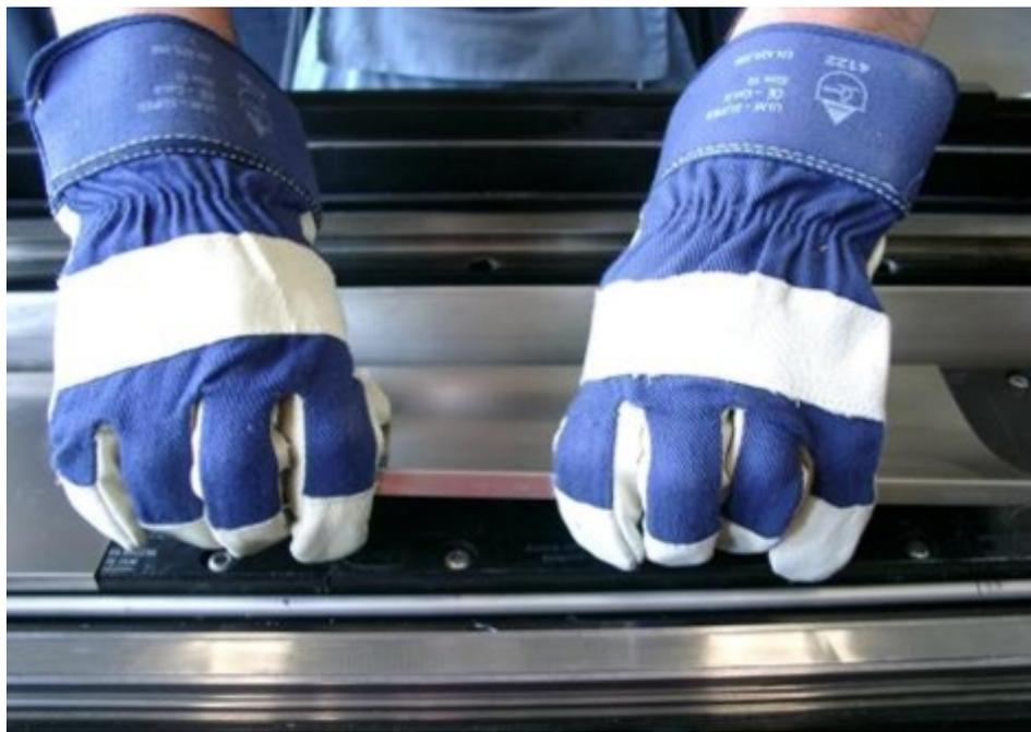
图 4-10 分段式盖板的拆卸
