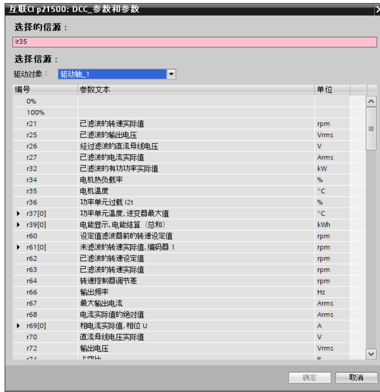
图 6-23 互联一个 BICO 输入参数时显示的文本参考
