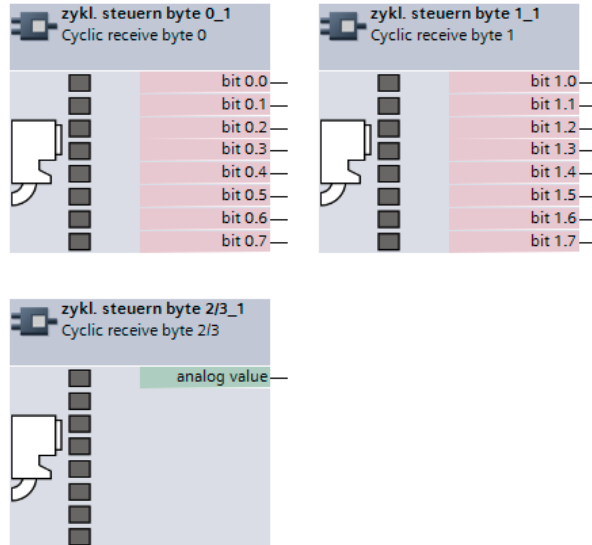
Рисунок 2-11 Циклические данные в SIMOCODE pro, базовый тип 1, 4 байта
