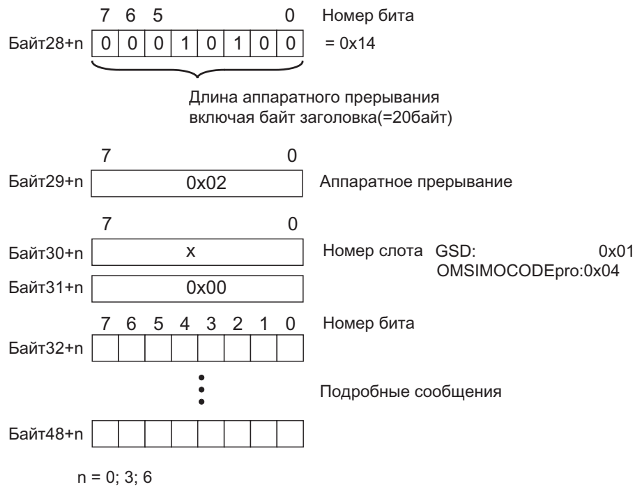
Рисунок 2-9 Структура аппаратного прерывания
