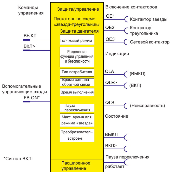
Рисунок 4-22 Схема функции управления «Пускатель по схеме «звезда-треугольник», функциональный блок «Защита/Управление»
