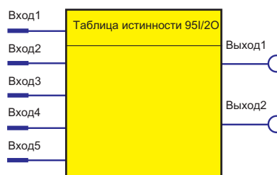
Рисунок 4-98 Элементы логической схемы «Таблица истинности 5I / 2O»
