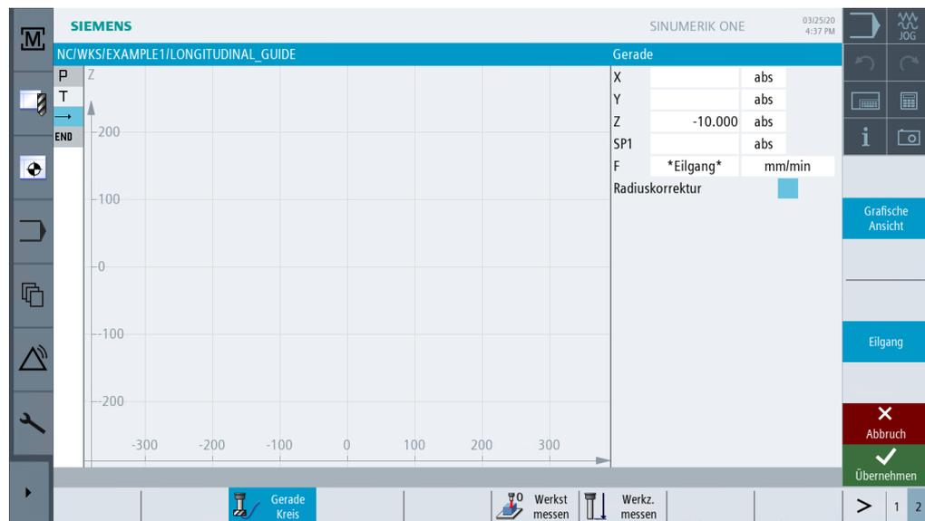
Bild 7-15 Verfahrweg eingeben - Werkzeug in Z positioniert
