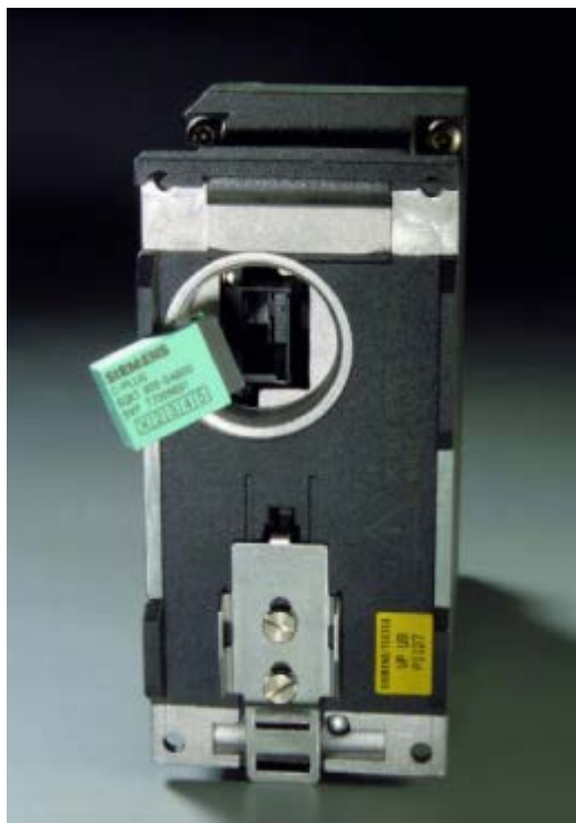
图 2-2 以 X-200 为例说明 C-PLUG 和插槽
