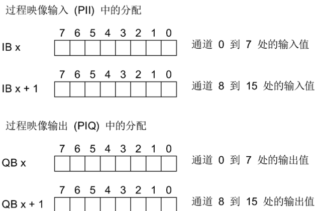
图 4-1 地址空间 IO-Link DIQ 16x24VDC/0,5A 8xM12
