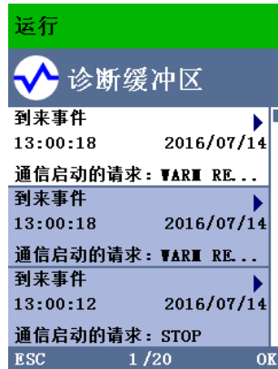
图 3-2 在 SIMATIC S7-1500 CPU 显示屏中，显示诊断缓冲区
