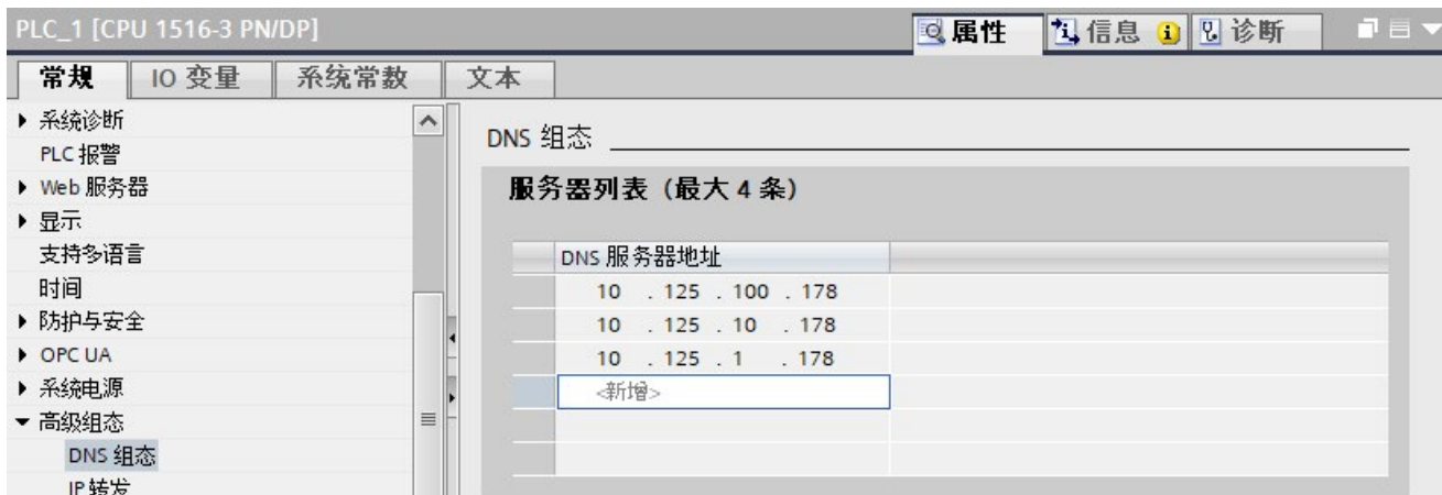
图 6-1 输入 DNS 服务器地址（以 CPU 1516-3 PN/DP 为例）
