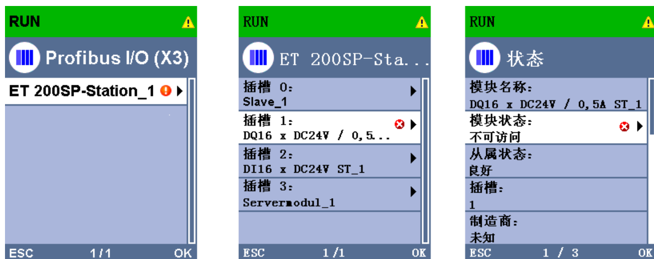
图 4-1 示例：站概览，模块概览，模块状态
