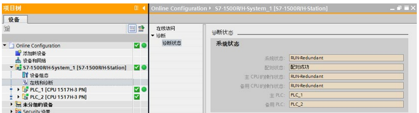
图 7-2 “在线与诊断”视图：S7-1500R/H 系统的诊断状态
