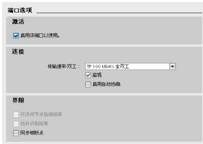
图 5-114 在 STEP 7 中优化端口设置以加快启动速度
