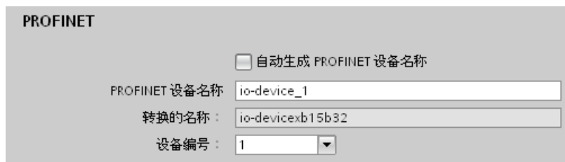
图 3-4 在属性中更改 PROFINET 设备的设备名称
