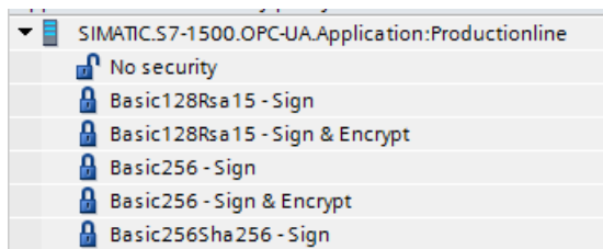
图 9-70 发现包含所有服务器端点的 OPC UA 服务器
