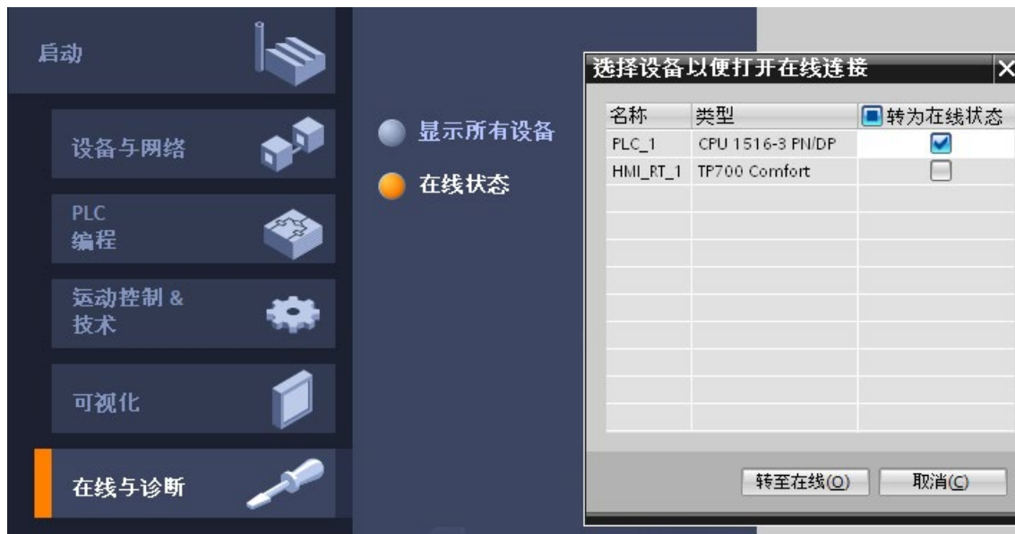
图 3-3 在 Portal 视图中选择在线连接的设备
