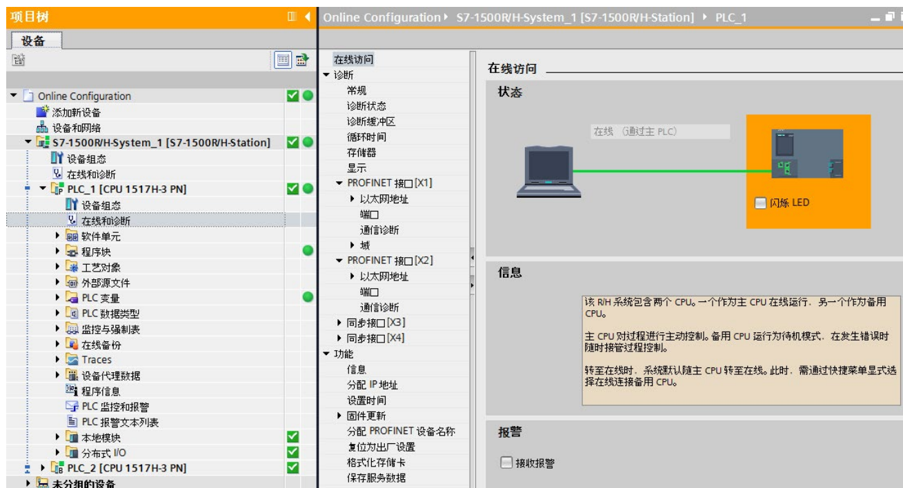
图 7-3 “在线与诊断”视图：CPU（RUN-Redundant 系统状态）
