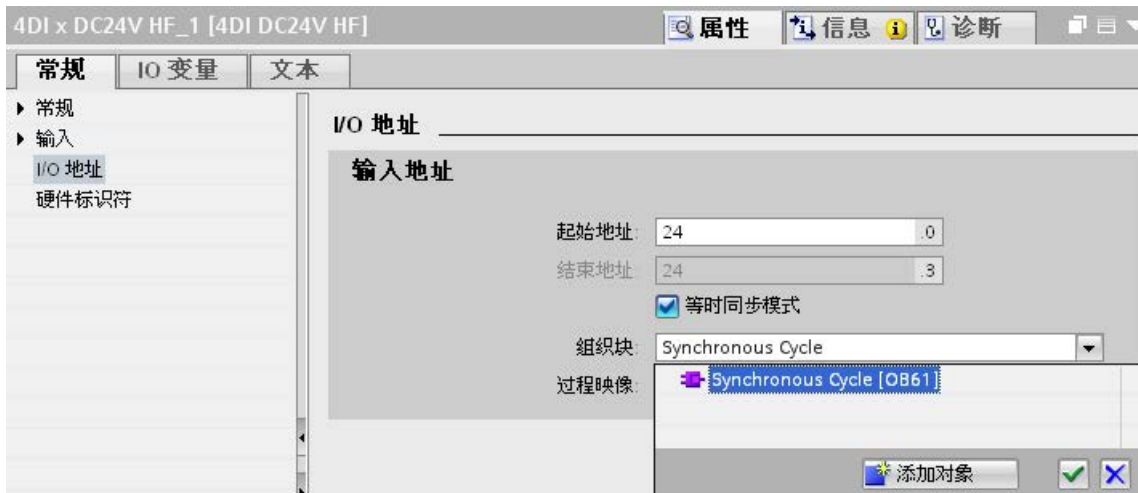
图 5-5 I/O 地址 - 创建同步循环中断 OB
