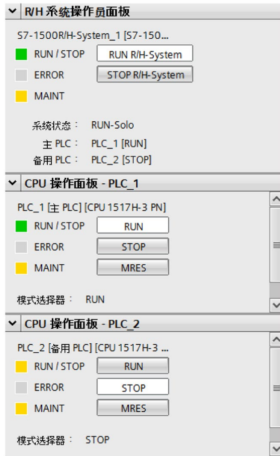
图 7-4 “在线工具”任务卡：操作面板（RUN-Solo 系统状态）
