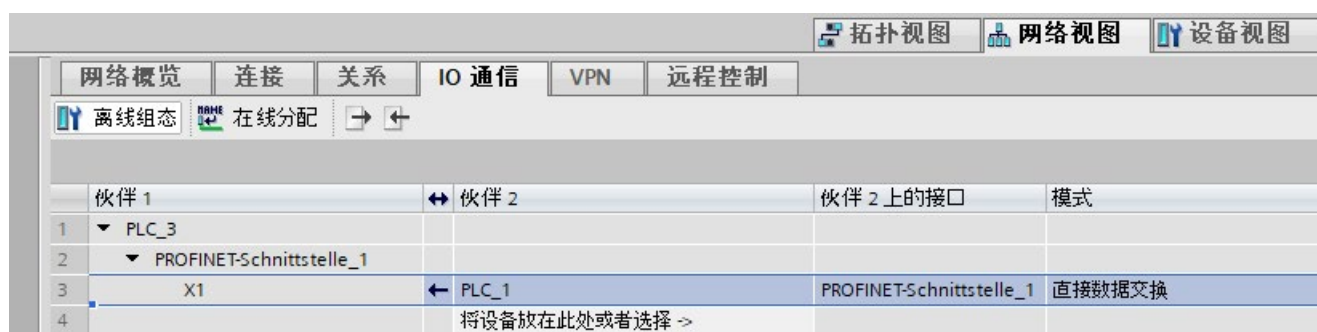
图 5-87 发送方 2 中用于直接数据交换的连接
