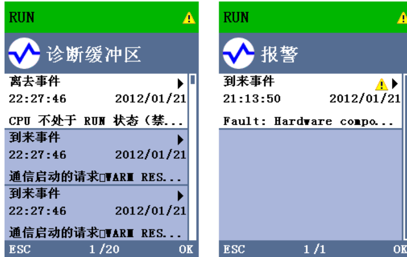
图 4-2 示例： 诊断缓冲区， 报警
