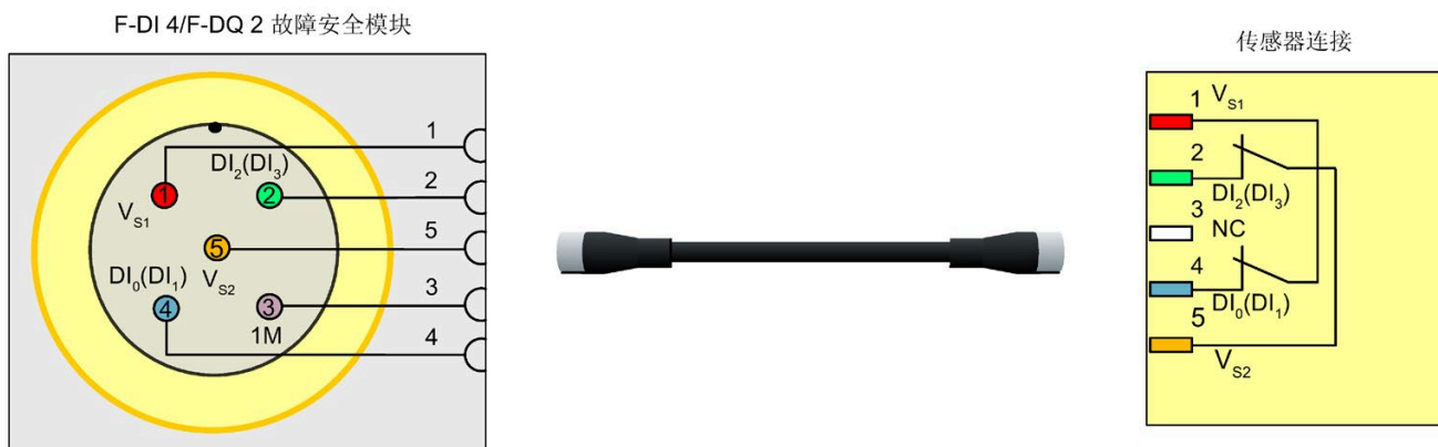
图 5-4 F-DI 应用模式 3 : 内部传感器电源 (所示为双通道传感器的 1oo2 评估)
