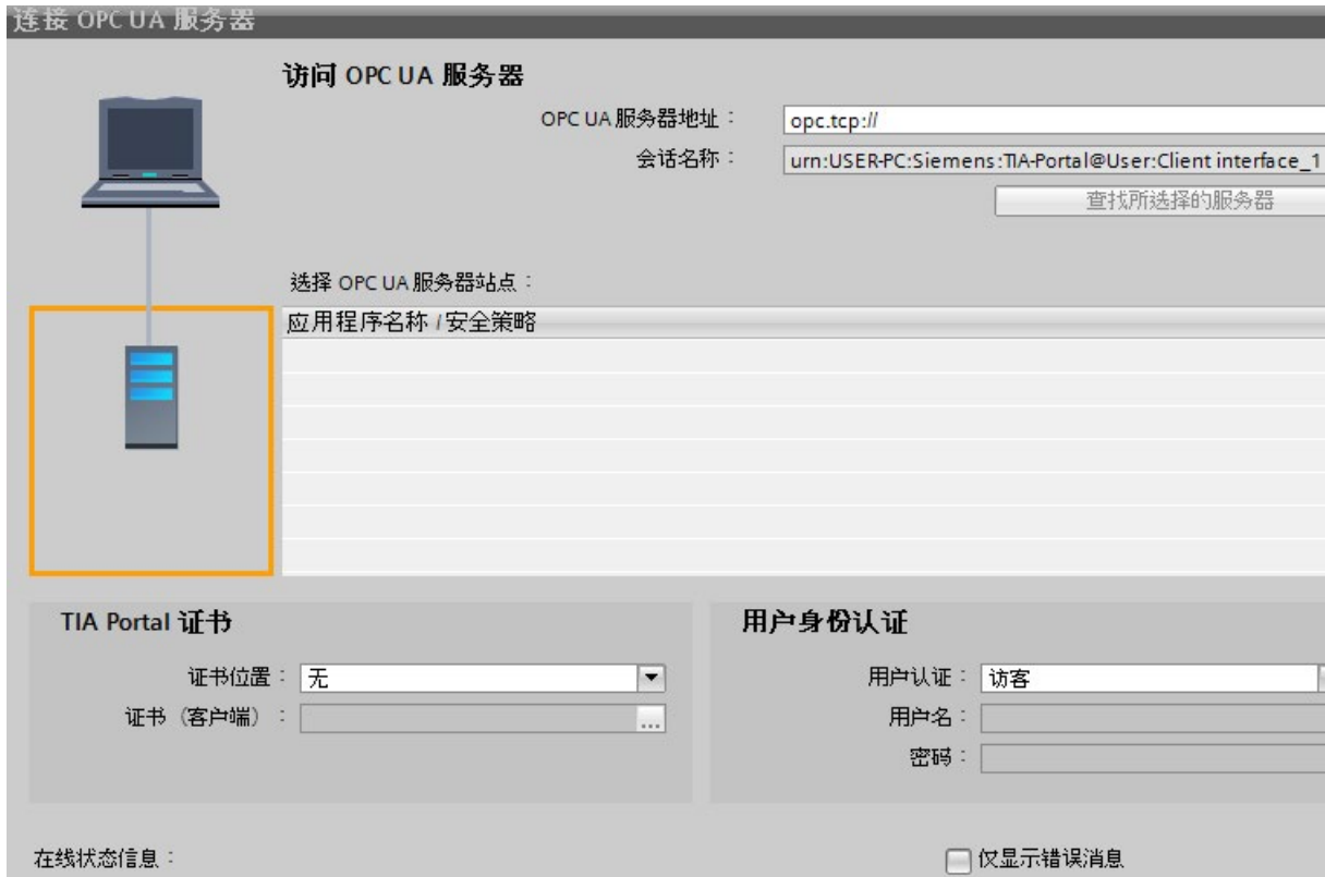
图 9-69 “连接到 OPC UA 服务器”(Connect to OPC UA server) 对话框
