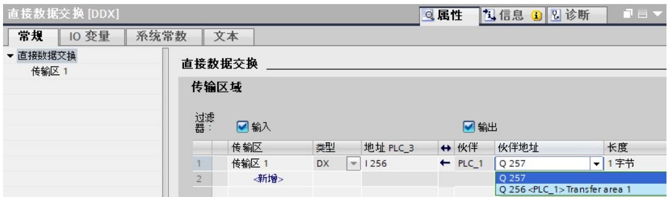
图 5-88 用于多个 IO 控制器直接数据交换的传送区
