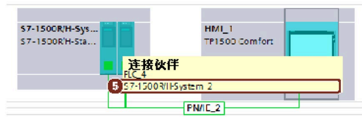
图 14-8 与 S7-1500R/H 冗余系统建立 HMI 连接
