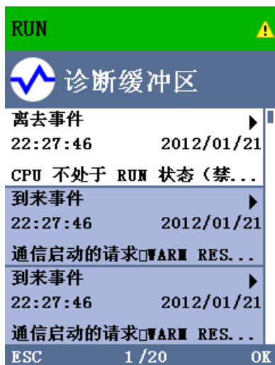
图 4-6 显示诊断缓冲区
