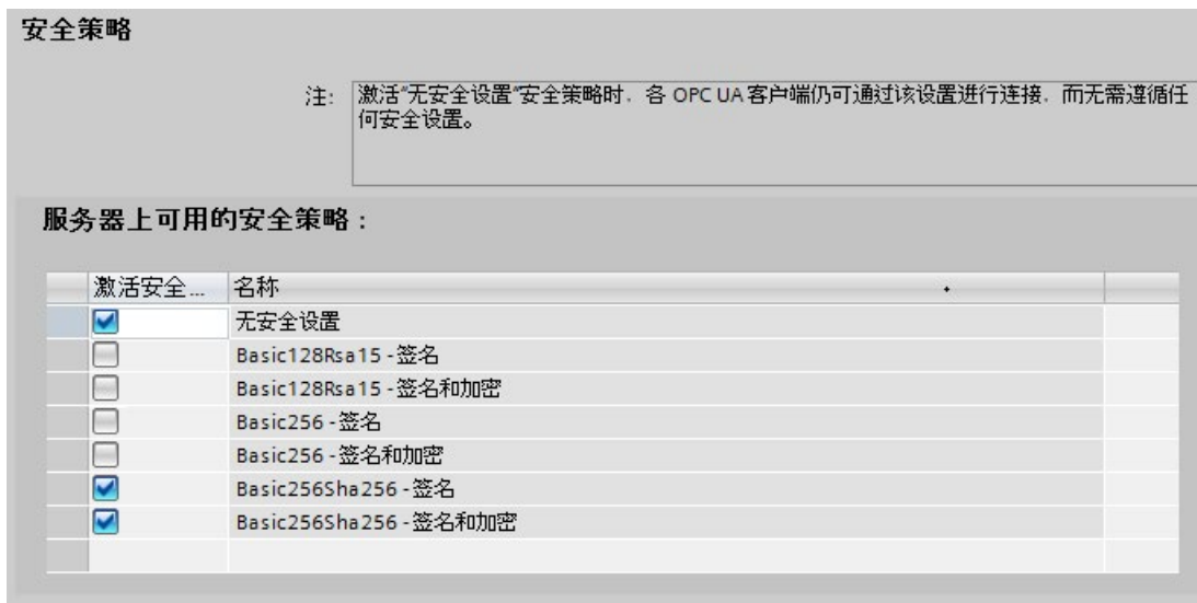
图 9-21 组态服务器的安全设置
