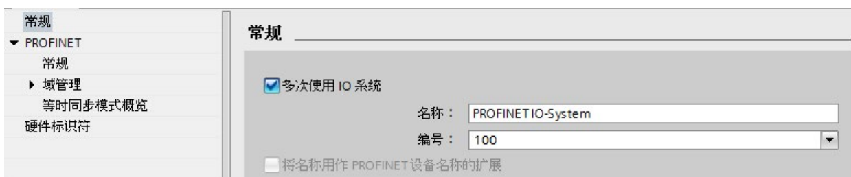
图 5-94 激活“可多次使用的 IO 系统”(Multiple use IO system)
