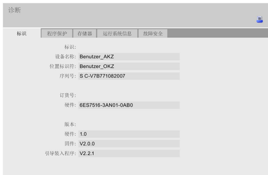
图 4-20 Web 服务器，“诊断”(Diagnostics) Web 页面
