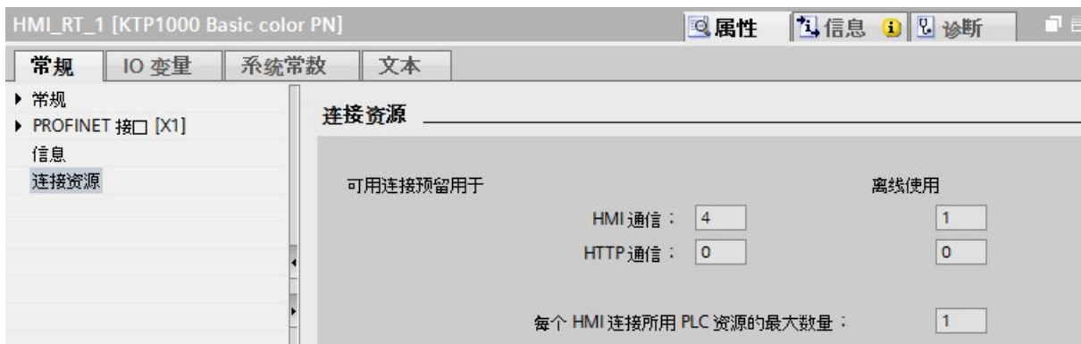
图 12-6 连接资源 - HMI 通信
