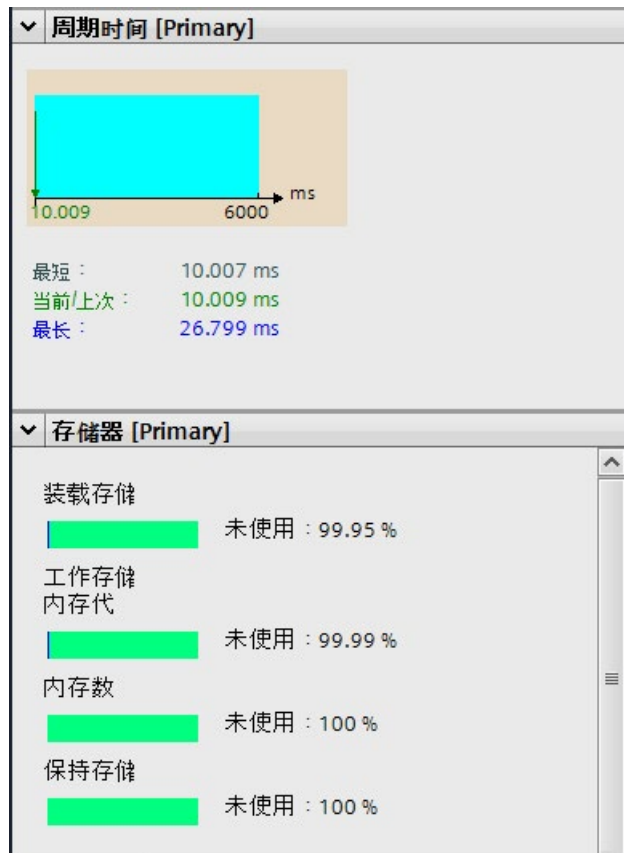
图 7-5 “在线工具”任务卡：主 CPU 的循环时间和存储器
