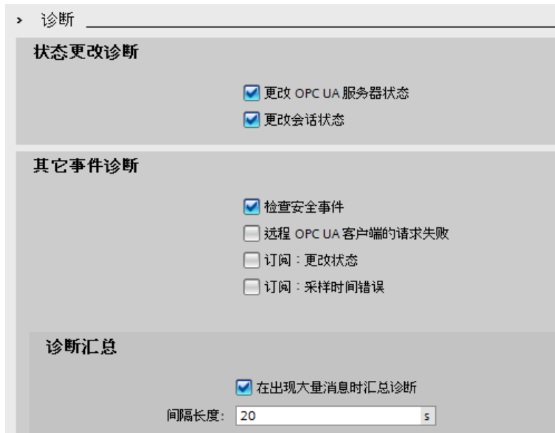
图 9-25 OPC UA 服务器的诊断设置
