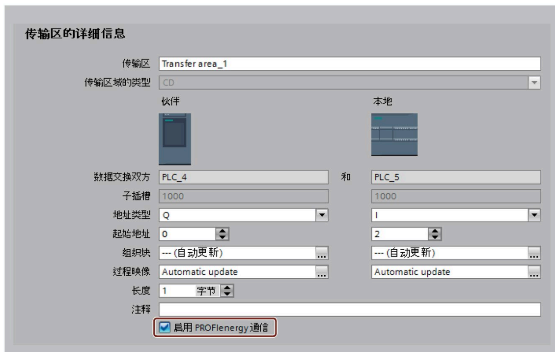
图 5-20 组态智能设备的 PROFINergy
