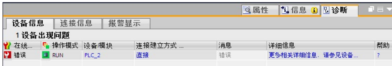
图 4-10 巡视窗口中“设备信息”选项卡中的诊断信息
