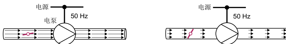
图 8-198 50 Hz 电源上使用泵和节流阀的流体控制
