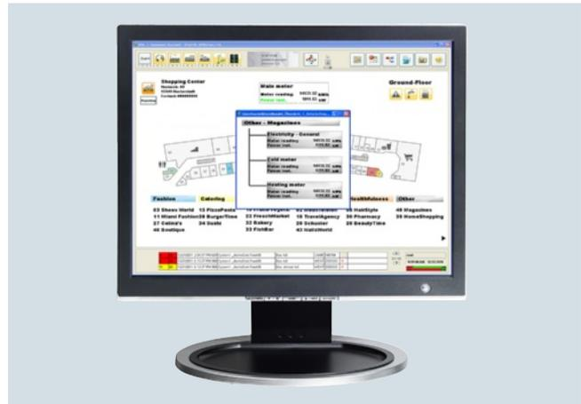
Bedienoberfläche der Energiemonitoringssoftware powermanager
