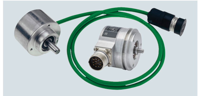
Inkrementalgeber mit sin/cos 1 V_{pp} und Klemmflansch einschl. Leitung mit Stecker sowie Inkrementalgeber mit RS422 (TTL) und Synchroflansch
