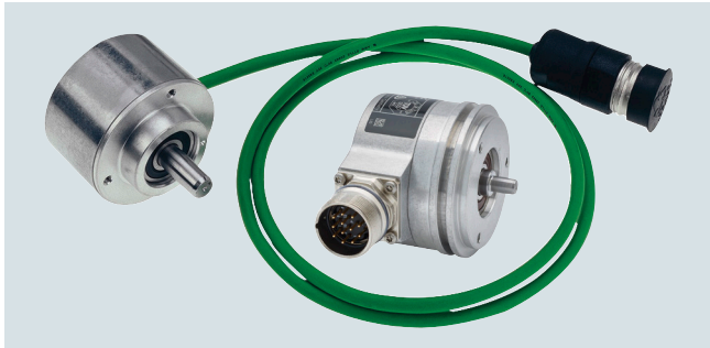
配有 sin/cos 1 V pp 和夹紧法兰、同时配套提供带有插头的电缆的增量编码器，以及配有 RS422（TTL）和同步法兰的增量编码器
