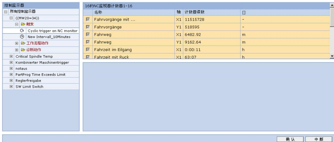
图 3-19: 用于服务器触发器的NC监视器计数器
