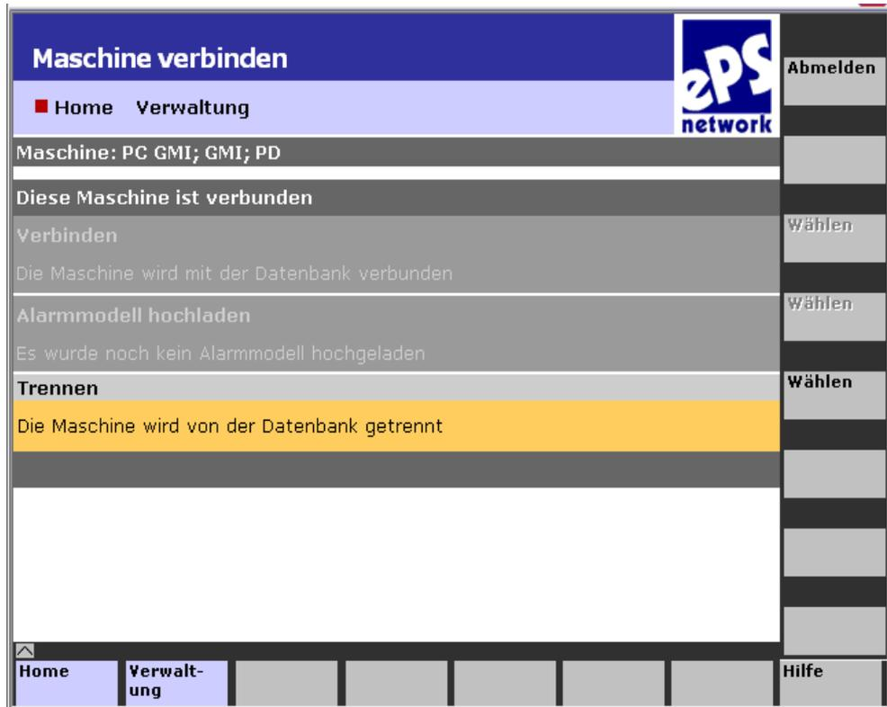
图 6-13: 在 HMI 上断开机床
