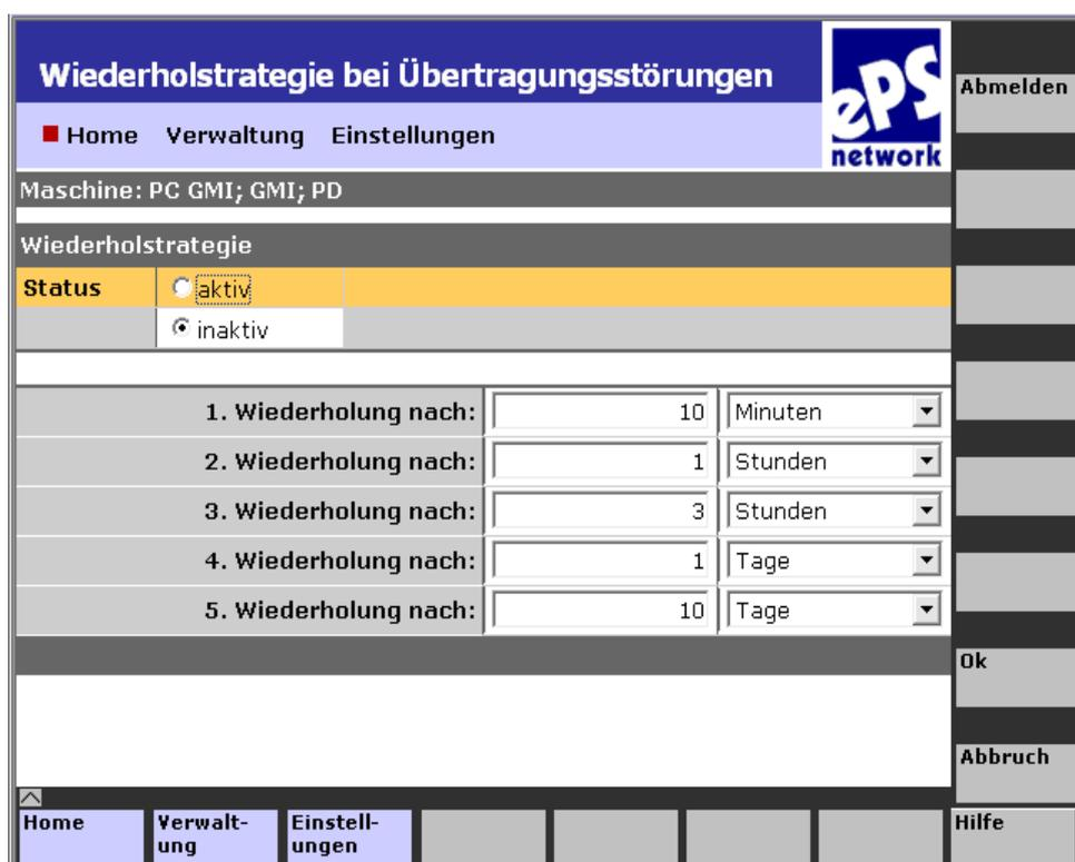
图 6-22: HMI 上的重复策略配置
