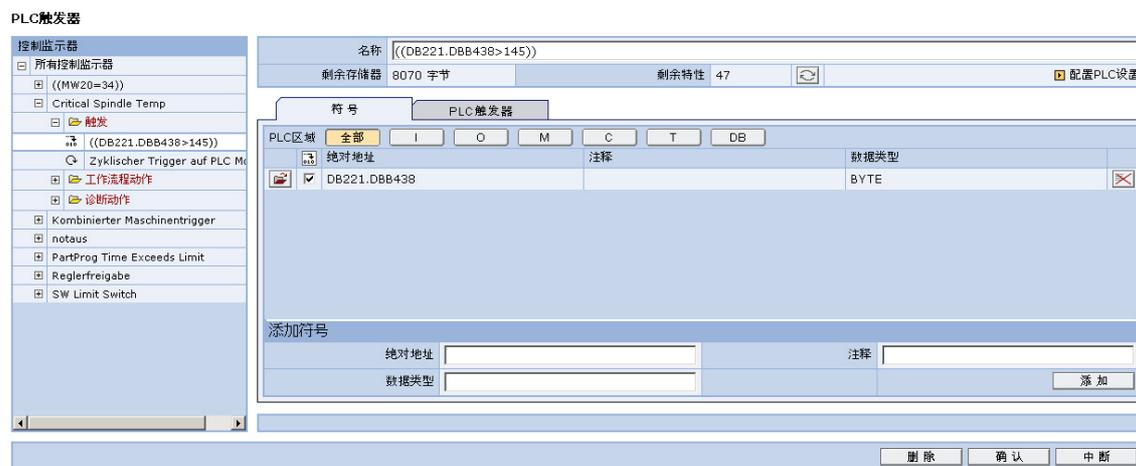
图 3-14: PLC 触发器: 添加地址
