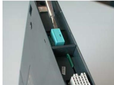
Bild 3-1 C-PLUG in den CP einsetzen und C-PLUG mit Hilfe eines Schraubendrehers aus dem CP entnehmen
