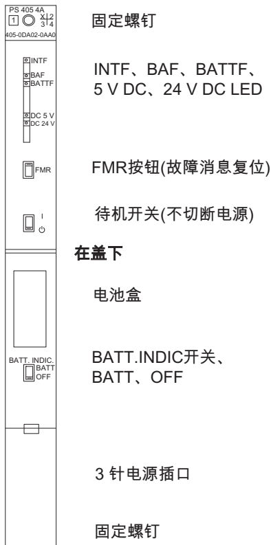
图 3-9 PS 405 4A 操作员控件和监视元件
