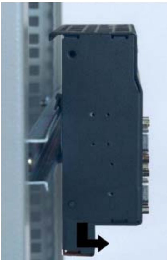
Bild 28. Demontage von der Hutschiene
