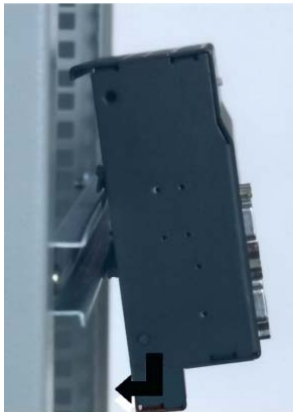
Bild 27: Montage des OSM auf einer DIN Hutschiene
